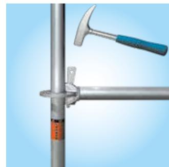
Un golpe con martillo en la cuña convierte la conexión en una insuperable unión fija, (utilizar un martillo de metal de mínimo 500 gr. hasta que el golpe rebote).
