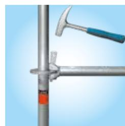
Mediante un golpe de martillo metálico de 500 gr. hasta rebote, se consigue un cierre efectivo.
