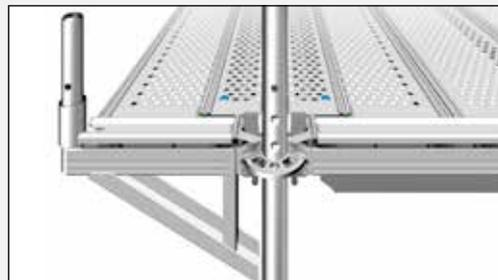
La **lámina cubre huecos 5** se puede utilizar entre dos plataformas de andamio tanto del sistema Blitz como Allround. El hueco máximo a cubrir será de una anchura de hasta 20 cm.
