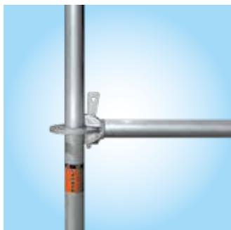
La roseta sin cajeado ni rebordes evita la posible obstrucción con hormigón, espuma, suciedad, etc. que podría dificultar el montaje.
