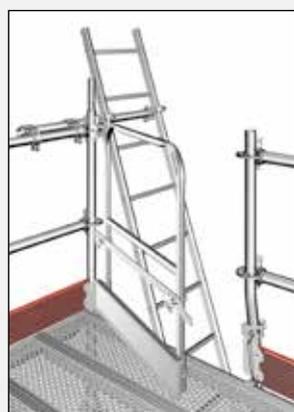
La escalera para grapar sigue las instrucciones según DIN EN 131, individualmente o unida a cualquier otra hasta llegar a la altura permitida. Los tramos tienen que apoyarse debidamente y asegurarse mediante clips adaptadores con muelle.
