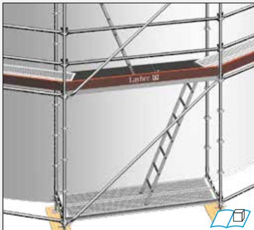
Colocación de la **plataforma Robust con trampilla de apertura lateral 10**
