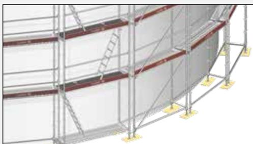
La **horizontal "U" angular (0,73 m. / 15° - 44° / WAF 19) 3** se utiliza en andamios circulares de gran diámetro elaborados con pié común (un sólo vertical interior).
